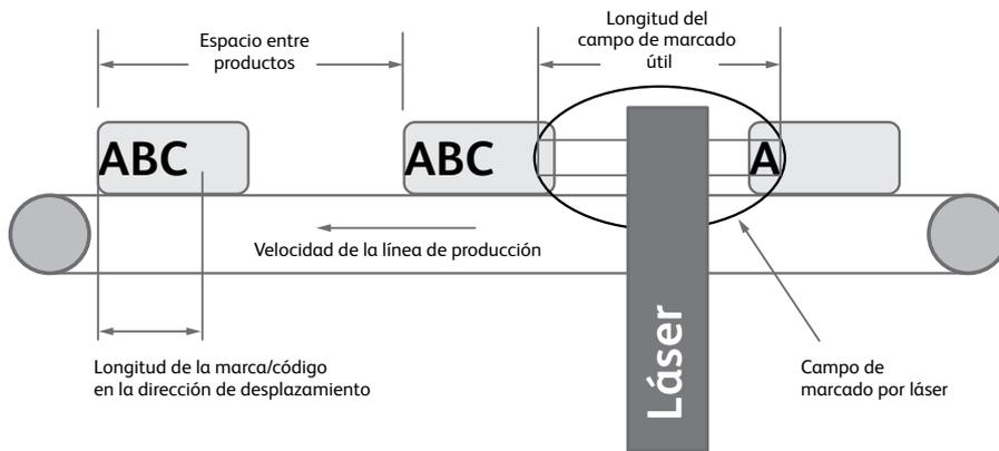
En la imagen de la izquierda se puede ver una fila de productos que se desplazan de derecha a izquierda. El área ovalada muestra el campo de marcado, que se denomina en ocasiones "espacio de marcado", es decir, el período en el que el láser puede marcar el producto. La combinación óptima entre el espacio de marcado y la línea de producción se logra cuando el espacio de marcado se puede aprovechar al máximo. Esto ocurre cuando se cumple lo siguiente:
