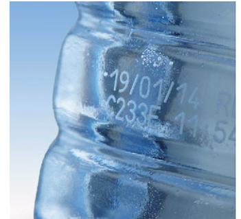
El tiempo de marcado suele consistir en el tiempo real en el que el láser realiza el marcado más el tiempo que tarda en saltar de un carácter al siguiente. La optimización del tiempo de marcado real frente al tiempo de salto constituye otro método de maximización del tiempo disponible para el marcado. El tiempo de salto es un tiempo de inactividad formado por los saltos, el tiempo de espera y el tiempo de desaceleración y aceleración de los sistemas galvanométricos.
