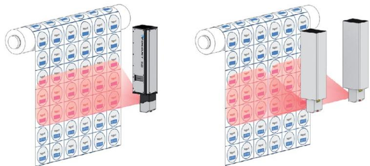
**Un** láser de Videojet con un espacio de marcado de 485 mm de ancho
