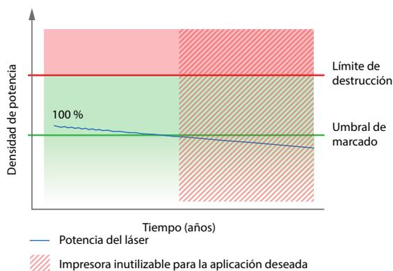
Por ejemplo, una especificación habitual para un láser de Videojet de 30 W consiste en una configuración del 80 % que equivale a 24 W.
