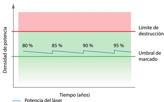
Para compensar la pérdida de potencia y garantizar que el láser sea perfectamente capaz de alcanzar el rendimiento deseado incluso después de 5 a 7 años de funcionamiento, se deben realizar todas las pruebas de marcado iniciales con menos del 100 % de potencia. De esta forma, dispondrá de potencia adicional para el ajuste con el paso del tiempo.
