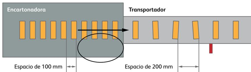
**Imagen superior:** La mejor posición de montaje es la que se lleva a cabo dentro de la encartonadora (círculo ovalado), por la que se guía el producto que va a marcarse. Por el contrario, el marcado en la cinta transportadora (aunque pueda parecer la opción más obvia) conlleva un riesgo de movimiento del producto y, por consiguiente, la posibilidad de una disminución de la calidad del marcado.
