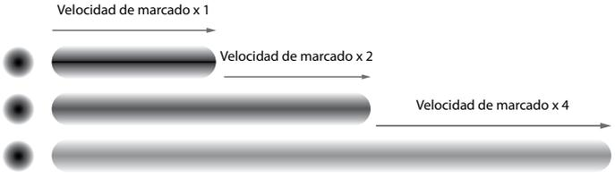
La potencia que emite el láser se extiende sobre un área formando una línea. Si se duplica la velocidad de marcado, se duplicará a su vez el área cubierta por el haz láser en el mismo período. Por este motivo, la densidad de potencia se reduce a la mitad. De igual modo, si se multiplica la velocidad de marcado por cuatro, la densidad de potencia se reducirá a un cuarto.
